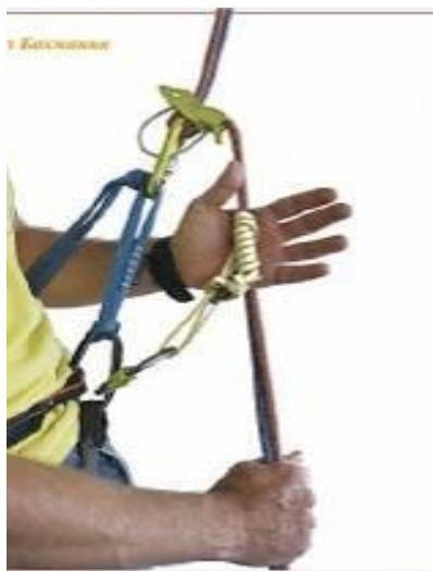
Рисунок 7. Спуск по вертикальным перилам с самостраховкой схватывающим узлом, расположенным ниже спускового устройства
